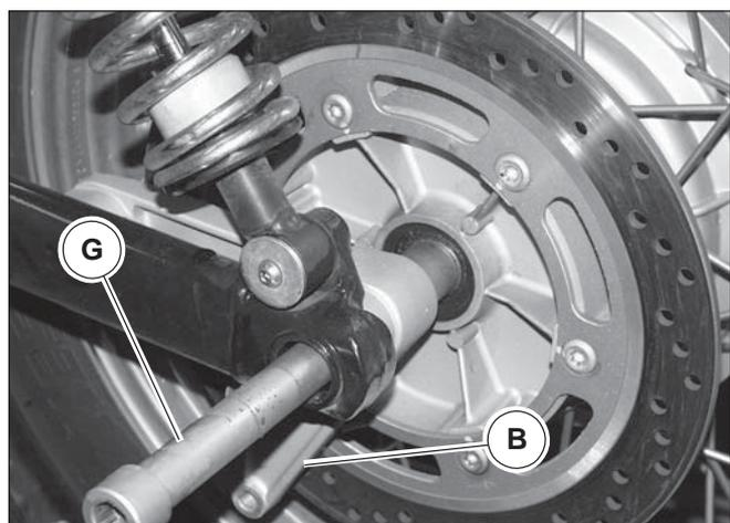
Per rimontare la ruota, invertire l'ordine di smontaggio tenendo presente di infilare la piastra porta pinza sul fermo del braccio sinistro del forcellone oscillante.
